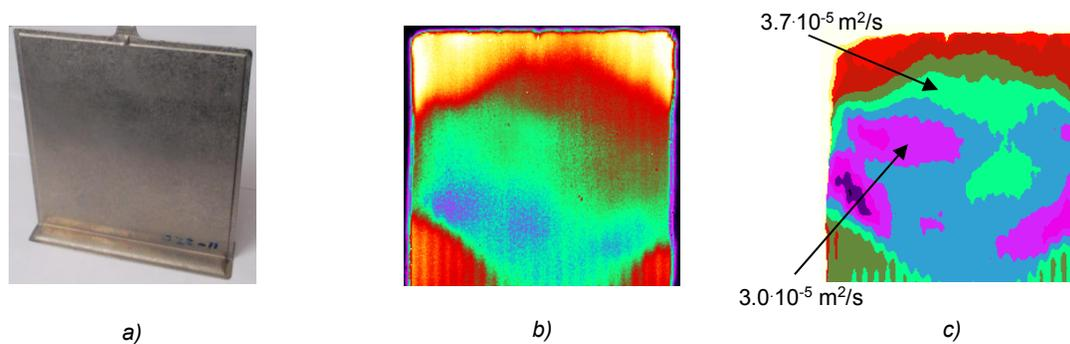
**Fig. 3.** Pulsed IR thermographic inspection of mini heat tubes: a – mini heat tube, b – best source image, c – diffusivity map
